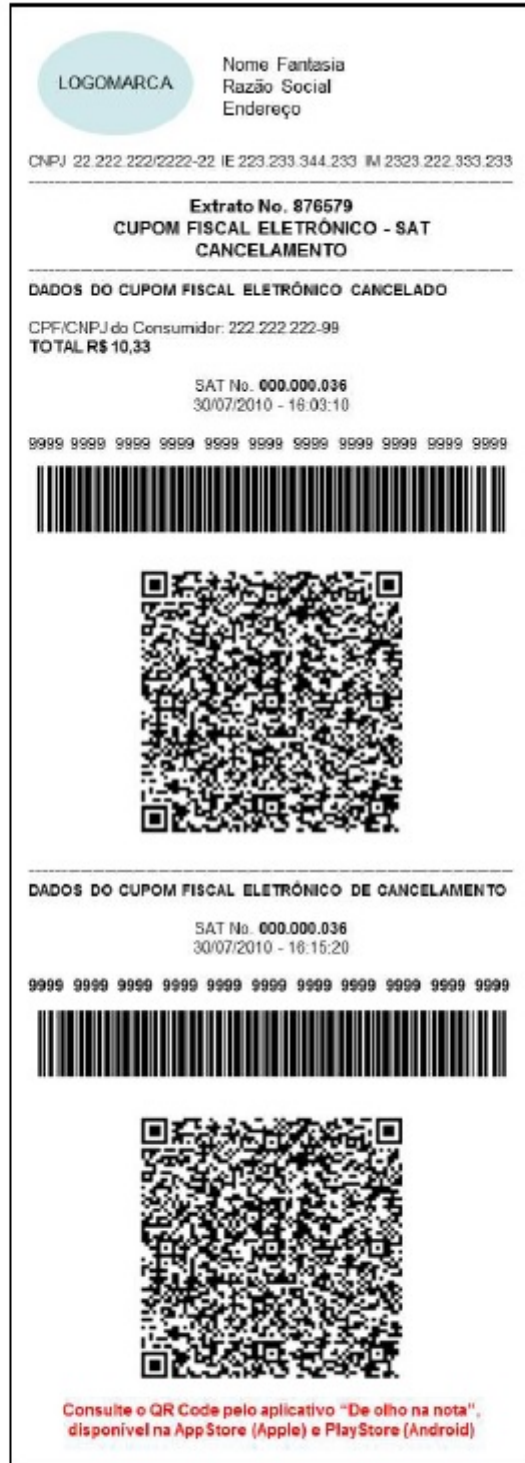
Figura 16 - Exemplo de impressão do Extrato do CF-e-SAT de Cancelamento em bobina contínua de papel largo (8 cm).
