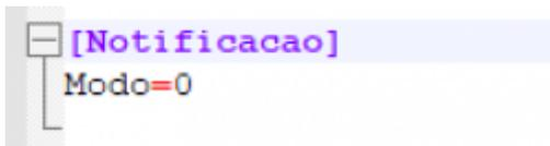
Nessa tag ao setar **0**, o sistema irá iniciar em modo servidor e ao setar **1** o sistema irá iniciar em modo terminal.
