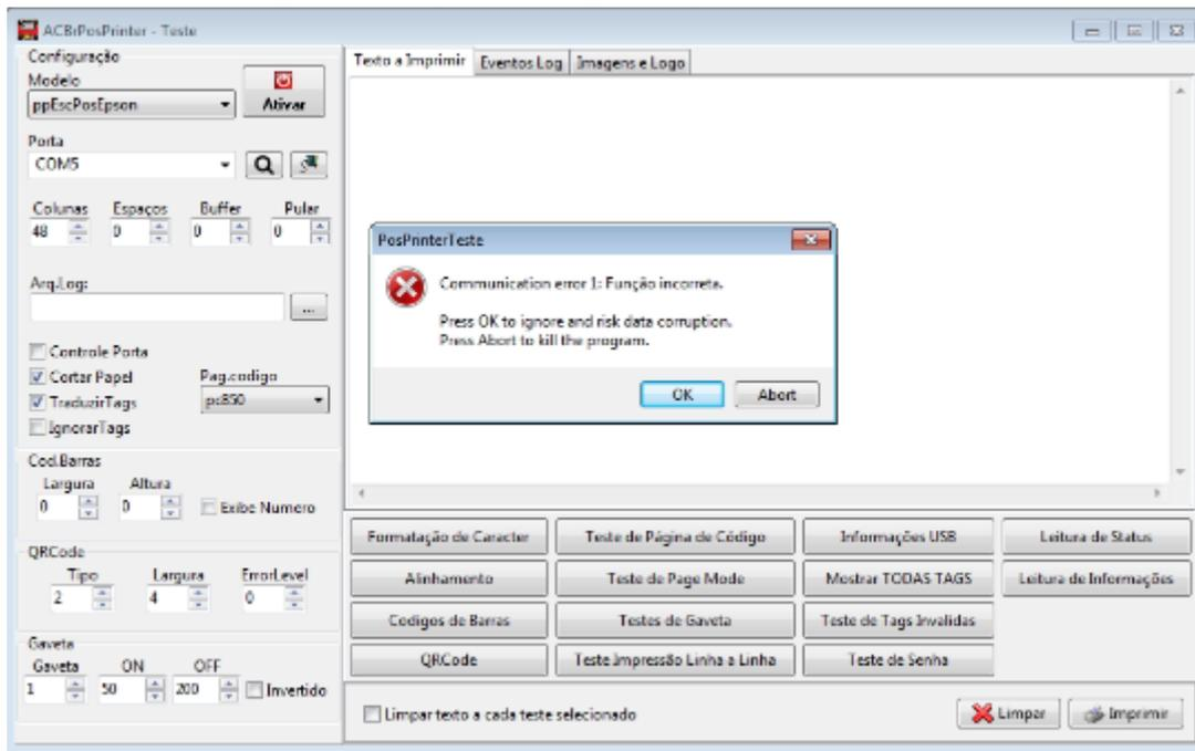
Além disso, constatamos que a comunicação da máquina com a impressora estava configurada como uma “Porta Serial Virtual” ao invés de uma comunicação USB e que bastava desconectar e reconectar a impressora para resolver o problema.
