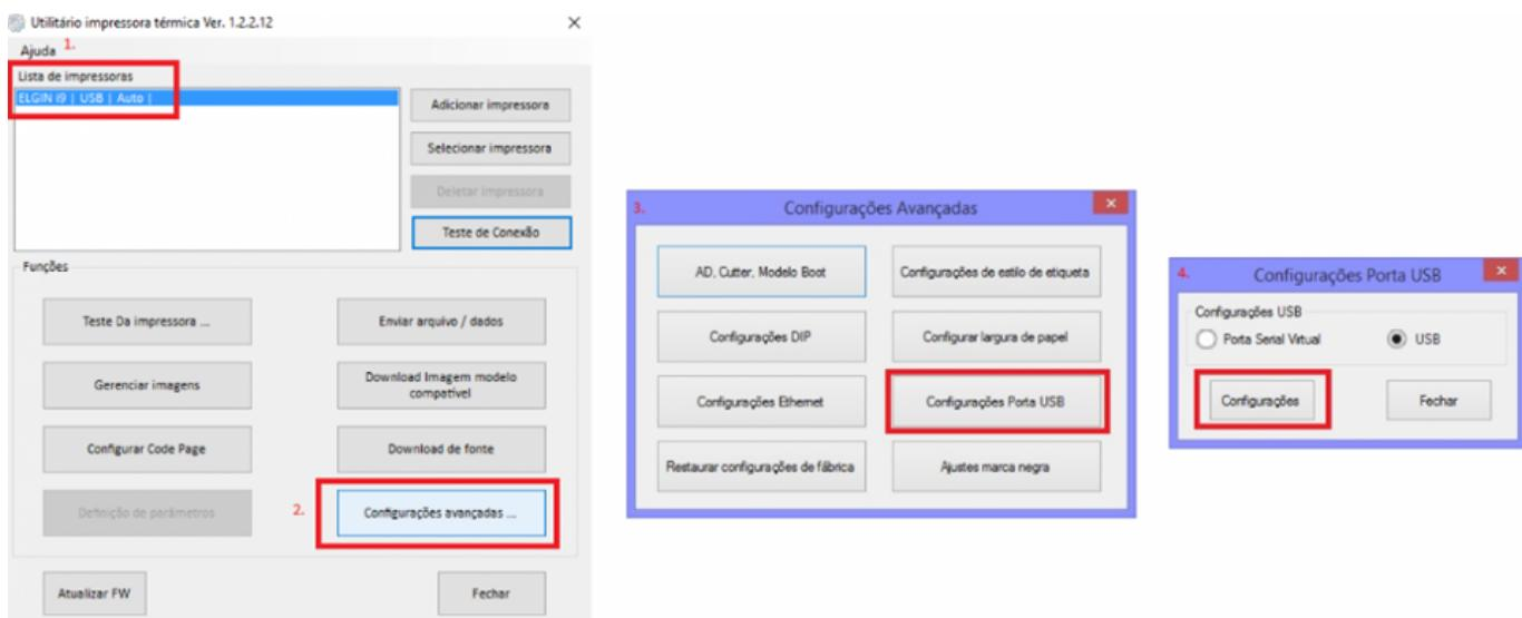
1. Acessar a “Lista de Impressoras” e selecionar a impressora a ser configurada; 2. Acessar “Configurações Avançadas ...”; 3. Acessar “Configurações Porta USB”; 4. Selecionar qual interface será usada (neste caso, a USB) e clicar em “Configurações” (o que já irá realizar a troca desejada da configuração da comunicação da interface); 5. Por fim, será necessário reiniciar a impressora para, assim, instalar o driver de acordo com a comunicação selecionada.
