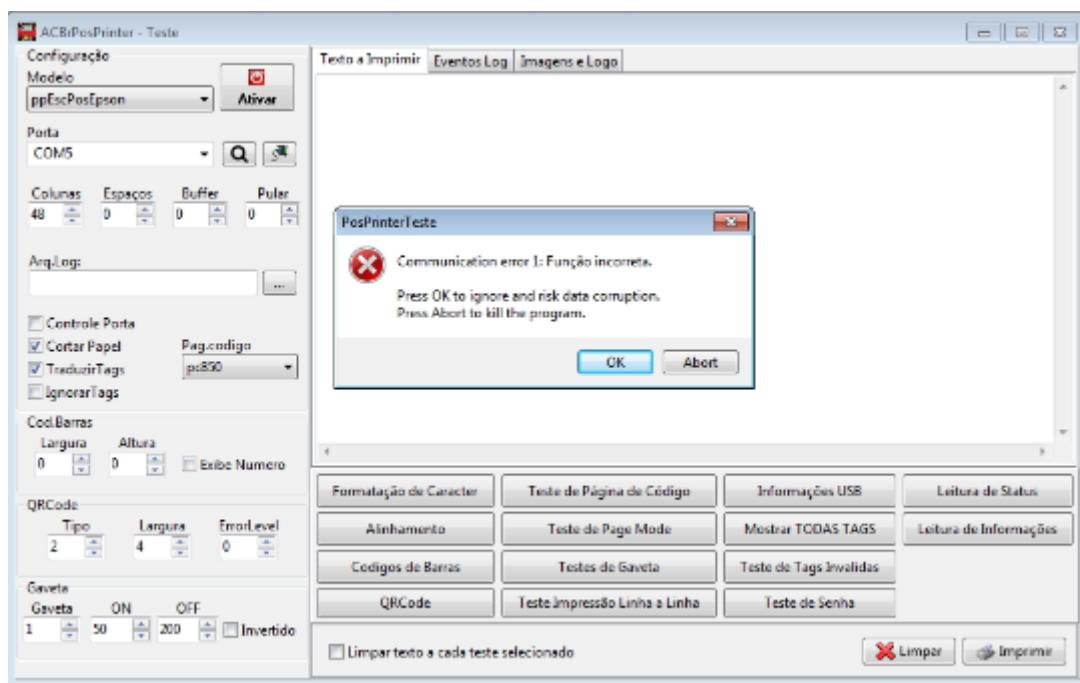
Além disso, constatamos que a comunicação da máquina com a impressora estava configurada como uma porta serial ao invés de uma comunicação USB e que bastava desconectar e reconectar a impressora para resolver o problema.
